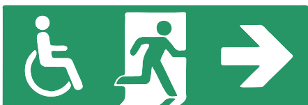
Ryc. 15.1. Symbol dostępnej drogi ewakuacyjnej (źródło ISO/FDIS 21542:2011)
